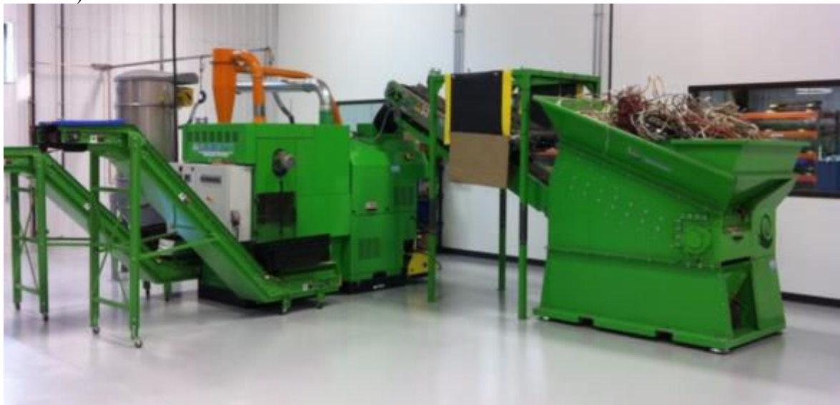
5.5. Pav. Guidetti Sincro 530 Eko kabelių smulkinimo ir separavimo įrenginys
